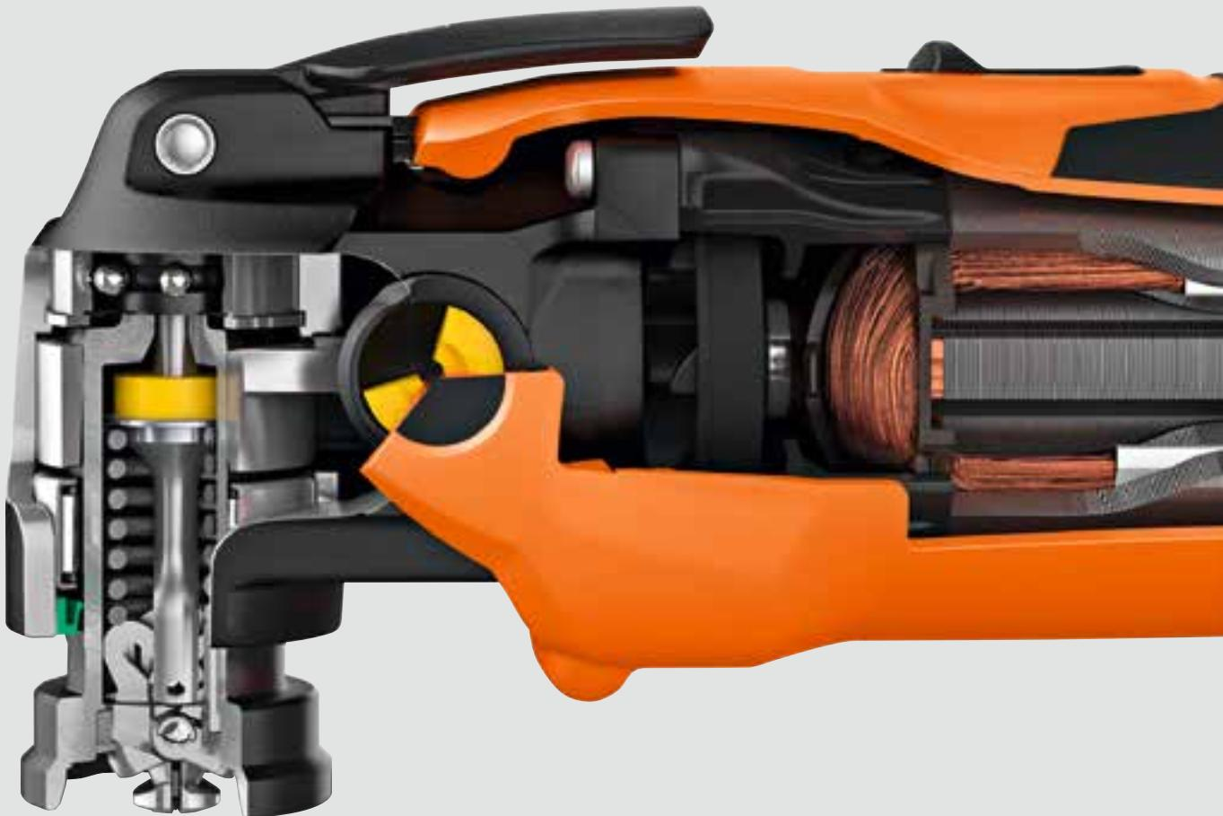
Protivibrační systém oscilačního náradí FEIN díky oddělení krytu a motoru na jedné straně snižuje vibrace a hlučnost chodu, což umožňuje výrazně komfortnější práci.
