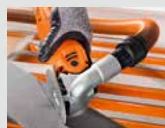
Perfektní odstraňování prachu pomocí odsávacího zařízení.
