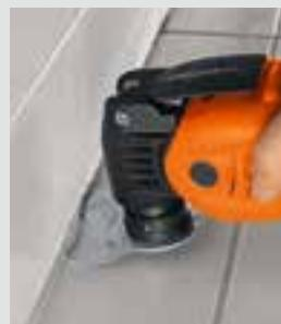
Odstraňování spárovacích těsnicích hmot.
