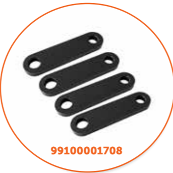
Sada upevňovacích destiček 4 x upevňovací plech s otvorem Ø 6,5 mm pro šroub M5 Ø 8,5 mm pro šroub M8
